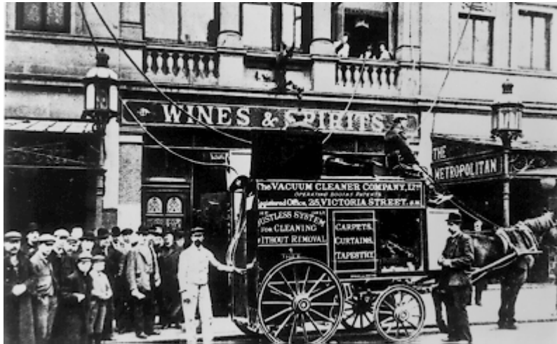
Benzinbetriebene Vacuum Pumpe nach Booth.
